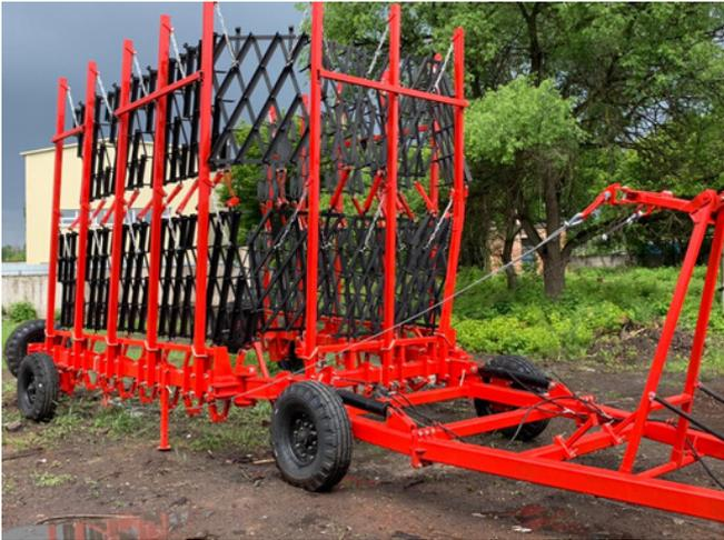
Сцепка БЗУ предназначена для составления тракторных гидрофицированных агрегатов и выполнения предпосевных работ, послепосевого вычесывания мелких сорняков и ухода за парами.
