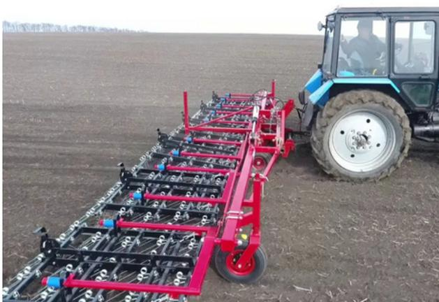
Борона пружинная АКТИВАТОР (Aktywator) – это рыхлитель (гвоздевка), предназначена для механического уничтожения сорняков при выращивании зерновых культур, картофеля, кукурузы, свеклы, рапса и овощей.
