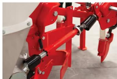
КАРДАНЫЙ ПРИВОД ВЫСЕВАЮЩЕЙ СЕКЦИИ
