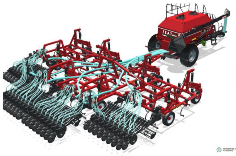
Культиваторная часть посевного комплекса оснащена пятью рядами стоек с плоскорежущей лапой. Сдвоенная пружина создаёт рабочее усилие на лапе 1000Н (120 кг), что позволяет качественно обработать почву на заданную глубину и обеспечивает абсолютное подрезание сорняков. За культиваторной частью агрегата устанавливается три вида рабочих органов:
