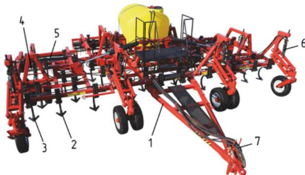
Культиваторы серии ПК шириной захвата от 3,6 до 12 метров — это универсальные прицепные агрегаты для предпосевной обработки почвы, обработки паров и основной обработки на глубину от 3 до 20 см.
