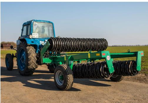
Катки кольчато-зубчатые ККЗ оснащены гидравлической системой для складывания секций в транспортное положение, управляемой с кабины трактора. Наличие колес позволяет быстрое и безопасное транспортирование орудия с поля на поле и по дорогам общего назначения.
