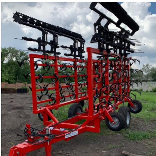
Культиватор работает на почвах, не засоренных камнями или засоренных отдельными мелкими камнями диаметром до 15 см, с абсолютной влажностью 13-20%, в почвенном слое 0...12 см.
